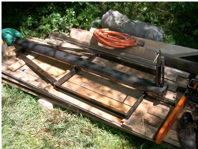
Dispositif de fermeture à barreau coulissant avant sa mise en place © R. LEGRAND
